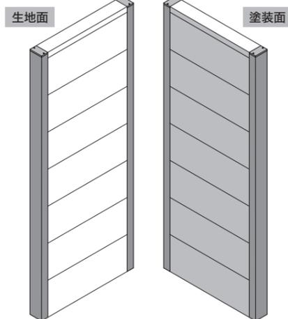
柱にベース材を取付、PSパネルを差し込み、横棧を取付ます。これを繰り返して最後にPS笠木を取付けて組立ては完成です。
