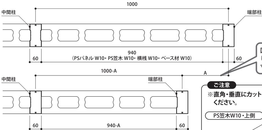
図のように柱をA寸法移動した場合、A寸法が切詰め寸法になります。
