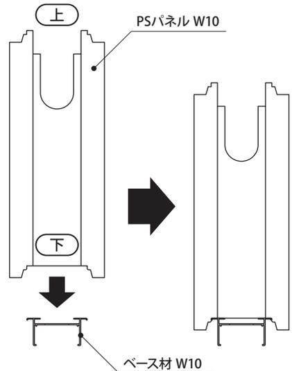
●90°コーナー柱とフリーコーナー柱、T字柱へのPSパネルW10の組み付けも、同様に行ってください。(T字柱はP.12参照)
