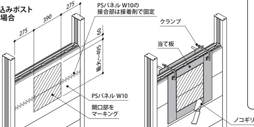
※開口部のPSパネルW10の接合部は、下図を参考に接着剤で結合してください。
