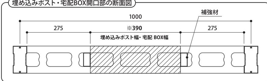
※390mmは一般的な埋め込みポスト幅・宅配BOX幅として表記しています。
