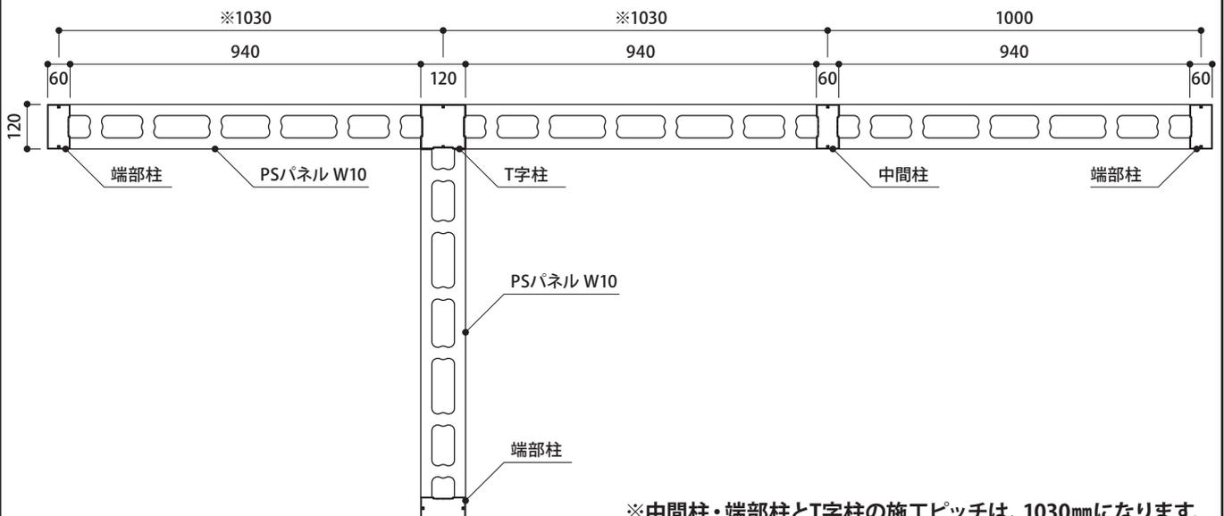
※中間柱・端部柱とT字柱の施工ピッチは、1030mmになります。
