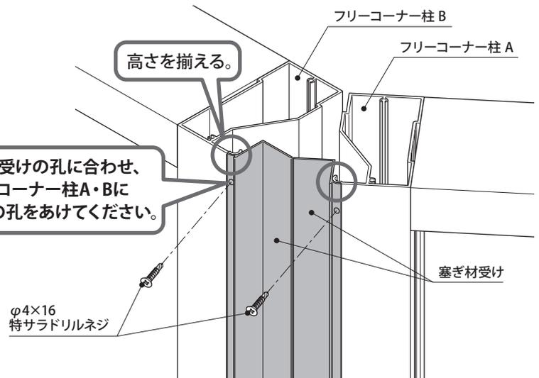
※塞ぎ材受けの孔に合わせて、フリーコーナー柱A・Bにφ3.5の孔をあけてください。
