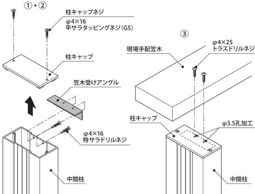
※上の図は中間柱の場合です。端部柱の場合にはPS笠木側(内側)にアングルを取り付けてください。
