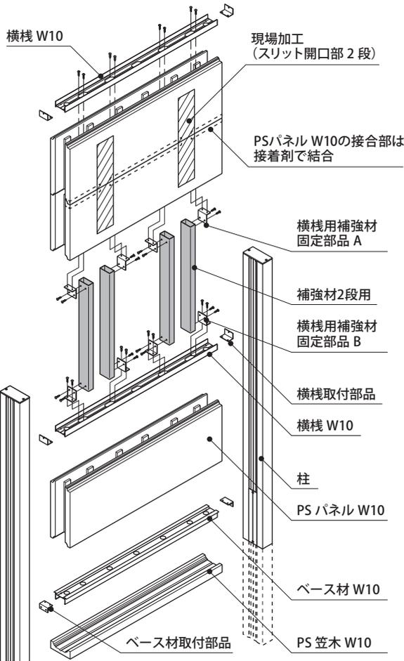
●補強材の取り付けには、上下の横棧W10に取り付け用の孔加工を現場で行ってください。
