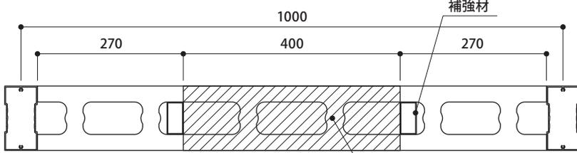
●上の図はPSパネルW10に□400mmの開き窓開口部断面になります。
