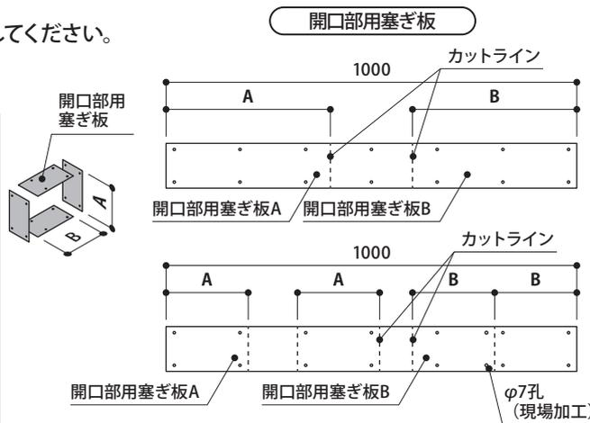
④開口部にカットした開口部用塞ぎ板を接着剤で貼り付け、コーススレッドL28で固定してください。
