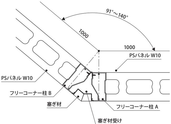
各部名称 連結仕様+T字柱仕様 (現場貼付タイプ・現場塗装タイプ・片面工場塗装タイプ共通)
