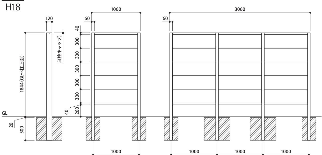
基本寸法図 (現場貼付タイプ・現場塗装タイプ・片面工場塗装タイプ共通)
