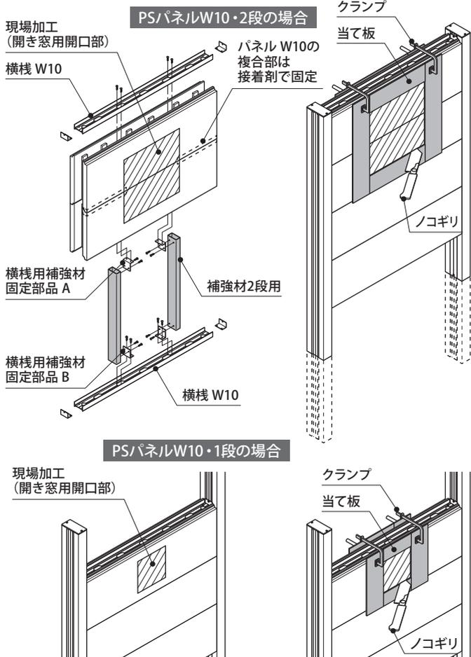
●補強材の取り付けには、上下の横棧W10に取り付け用の孔加工を現場で行ってください。
