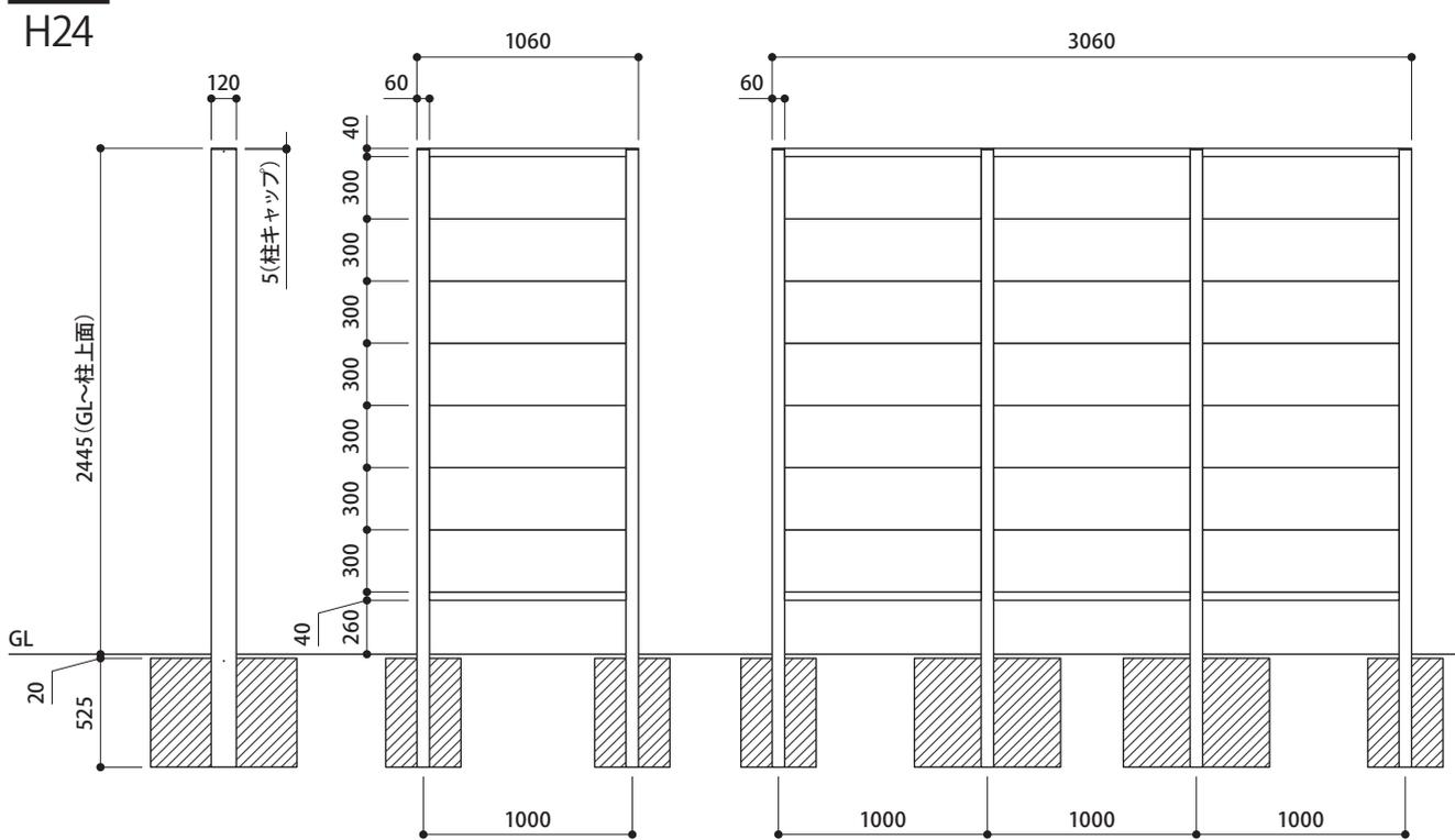
基本寸法図〈現場貼付タイプ・現場塗装タイプ・片面工場塗装タイプ共通〉
