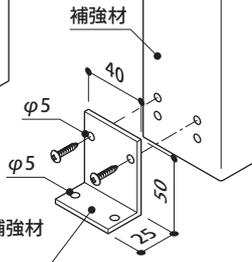
①下の図を参考に補強材を取り付けるベース材W10に、取り付け用の孔加工を現場で行ってください。
