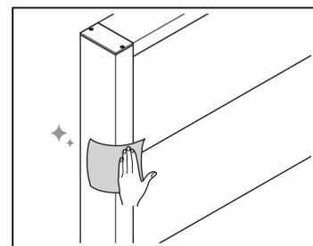
●接着剤は、表面に付着しているゴミ・土砂・油分等を除去してから塗布してください。
